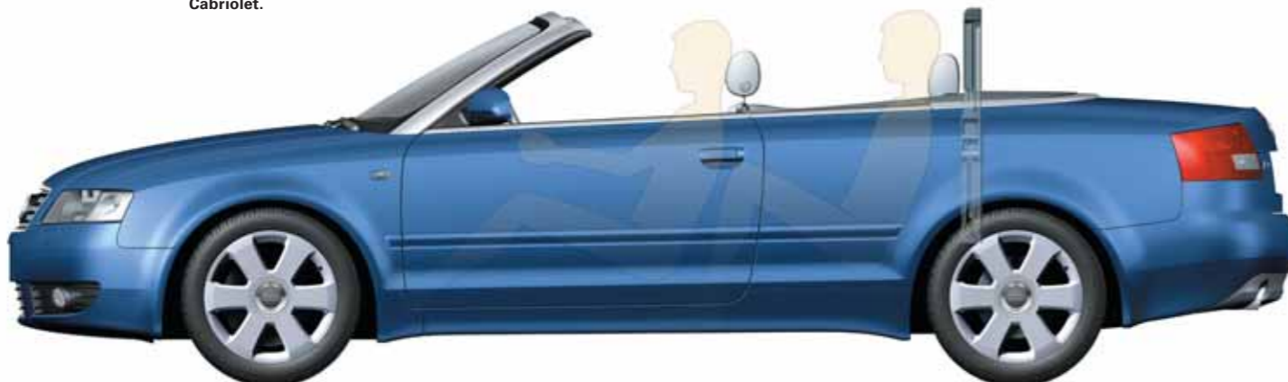
Aktives Überrollschutzsystem beim Audi A4 Cabriolet.
