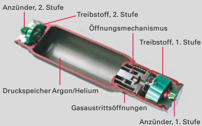
Hybridgasgenerator (zweistufig) für Beifahrerairbag. Quelle: Autoliv
