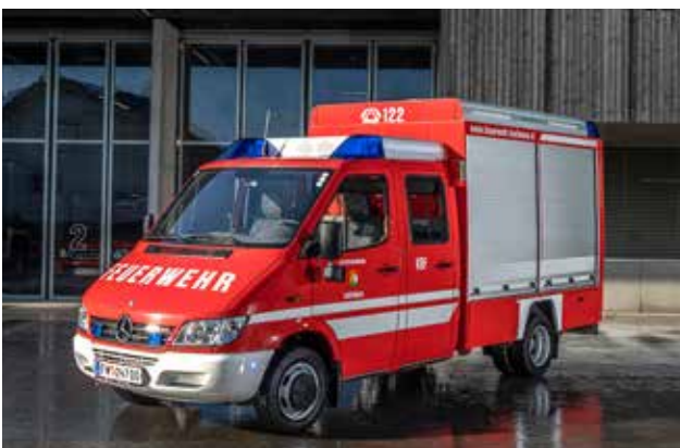
Kleinrüstfahrzeug, 1:5, Mercedes Sprinter 416 CDI, 165 PS, Baujahr 2005
