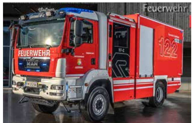
Versorgungsfahrzeug mit Containerverladeeinrichtung, 1:7, MAN-TGM 18.340 4x4, 340 PS, Baujahr 2021
