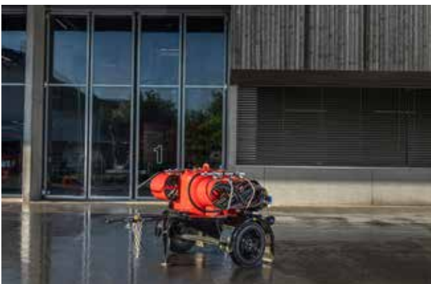
Pulverlöschanhänger, Minimax, 250 kg Löschpulver, Baujahr 1963
