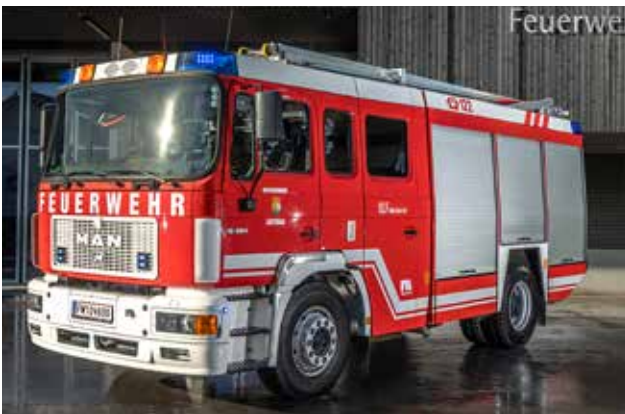
Universallöschfahrzeug, 1:8, MAN 18.264, 2.000 Liter Wasser, 250 Liter Schaum, 750 kg Pulver, 264 PS, Baujahr 1998
