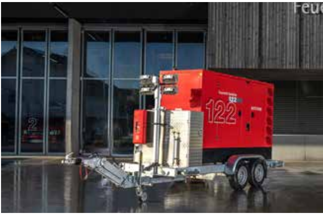
Notstrom-Anhänger, ETM, Dauerleistung 130 kVA/140 kW Standby, 4 Pole Bürstenlos AVR, Baujahr 2022
