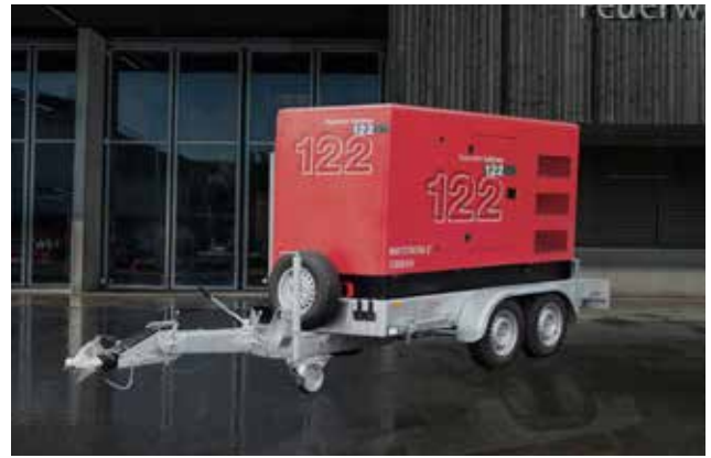
Notstrom-Anhänger, R.I.D. GmbH, Type 130 S-Series S/Mobil, Dauerleistung 130 kVA, 4 Pole Bürstenlos AVR, Baujahr 2023
