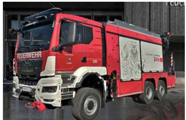
Schweres Rüstfahrzeug mit Kran, 1:2, MAN TGS 28.520 6x4-4 BL CH, 520 PS, Baujahr 2025
