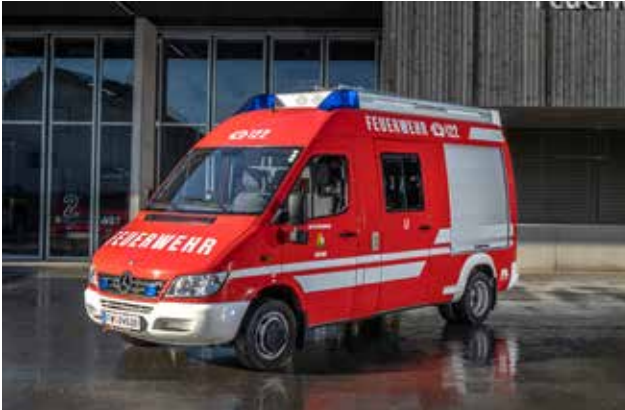
Löschfahrzeug, 1:8, Mercedes Sprinter 416 CDI/HD, 156 PS, Baujahr 2003
