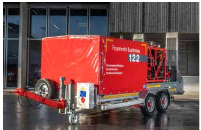
LUF H20 auf Tandemhänger, Hochwasser- und Löschwasserförderpumpe, Baujahr 2015
