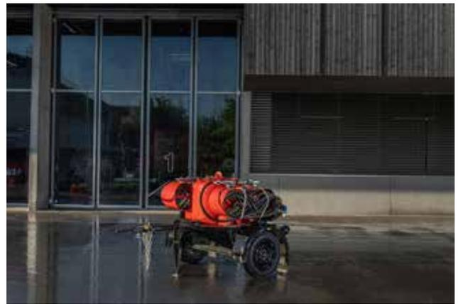
Pulverlöschanhänger, Minimax, 250 kg Löschpulver, Baujahr 1963
