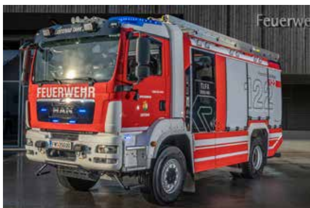
Tanklöschfahrzeug, 1:6, MAN-TGM 18.340 4x4, 3.000 Liter Wasser, 2 x 200 Liter Schaum mit CAFS-Anlage, 340 PS, Baujahr 2019
