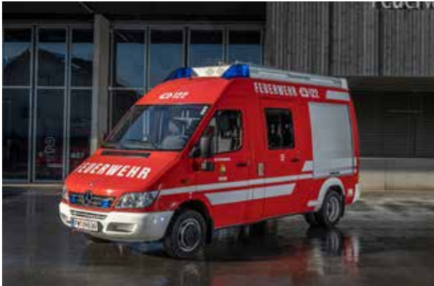
Löschfahrzeug, 1:8, Mercedes Sprinter 416 CDI/HD, 156 PS, Baujahr 2003
