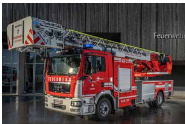
Drehleiter, 1:2, MAN 15.290, Magirus DLA(K) 23/12 L-AS, 290 PS, Baujahr 2012
