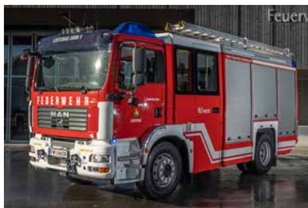
Rüstlöschfahrzeug, 1:6, MAN 18.330, 4.000 Liter Wasser, 250 Liter Schaum 330 PS, Baujahr 2008
