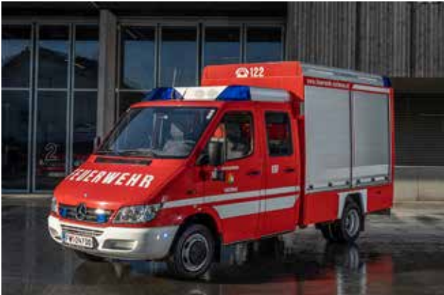
Kleinrüstfahrzeug, 1:5, Mercedes Sprinter 416 CDI, 165 PS, Baujahr 2005
