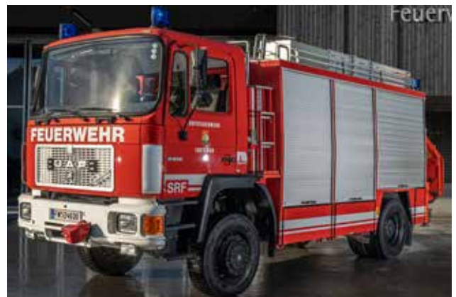
Schweres Rüstfahrzeug mit Kran, 1:2, ÖAF 17.232 FA, 232 PS, Baujahr 1992
