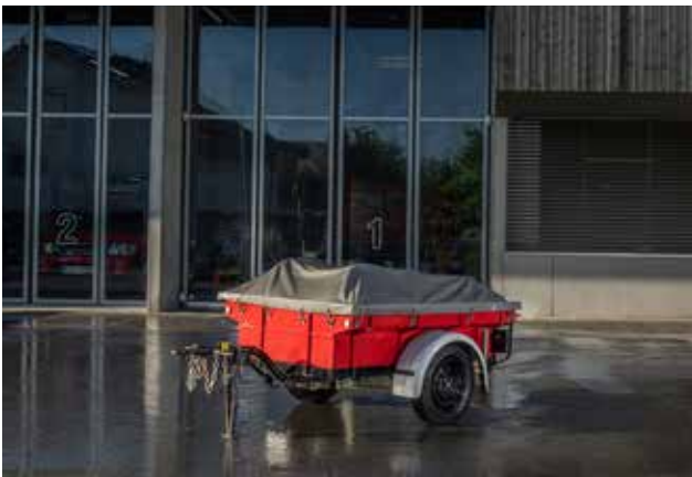
Schlauchanhänger, 3 x 100 m B-Schlauch, Baujahr 1974
