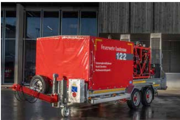
LUF H20 auf Tandemhänger, Hochwasser- und Löschwasserförderpumpe, Baujahr 2015
