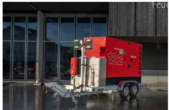
Notstrom-Anhänger, ETM, Dauerleistung 130 kVA/140 kW Standby, 4 Pole Bürstenlos AVR, Baujahr 2022
