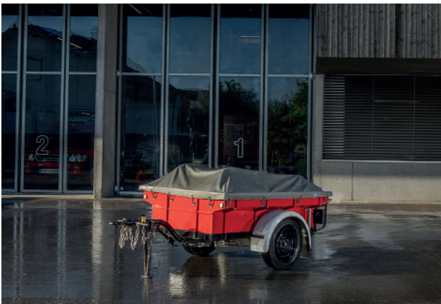
Schlauchanhänger, 3 x 100 m B-Schlauch, Baujahr 1974
