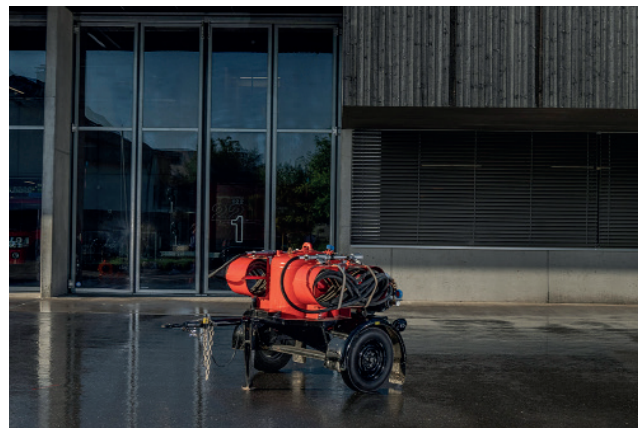
Pulverlöschanhänger, Minimax, 250 kg Löschpulver, Baujahr 1963
