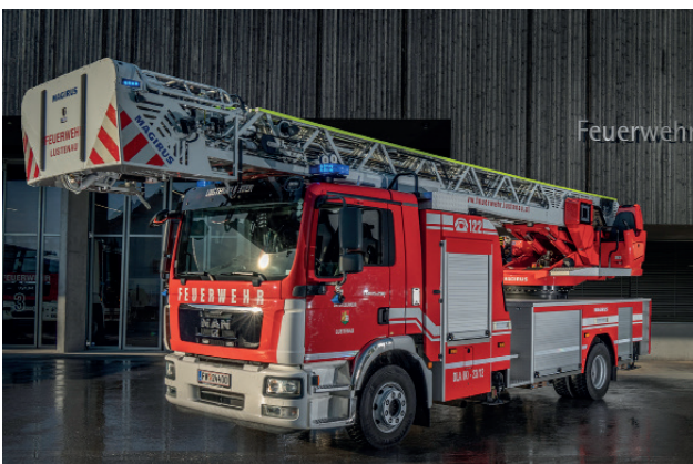
Drehleiter, 1:2, MAN 15.290, Magirus DLA(K) 23/12 L-AS, 290 PS, Baujahr 2012
