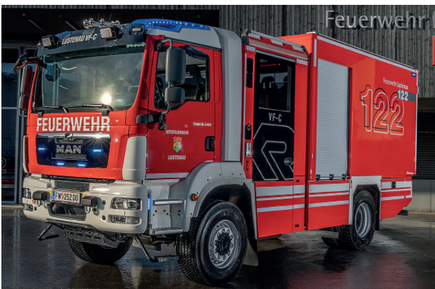
Versorgungsfahrzeug mit Containerverladeeinrichtung, 1:7, MAN-TGM 18.340 4x4, 340 PS, Baujahr 2021
