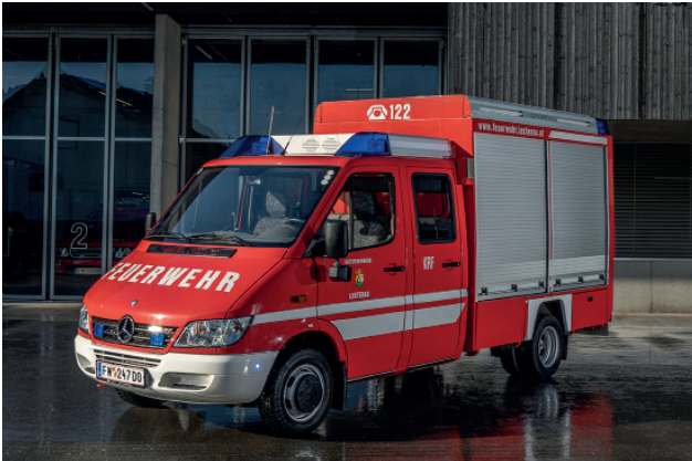
Kleinrüstfahrzeug, 1:5, Mercedes Sprinter 416 CDI, 165 PS, Baujahr 2005
