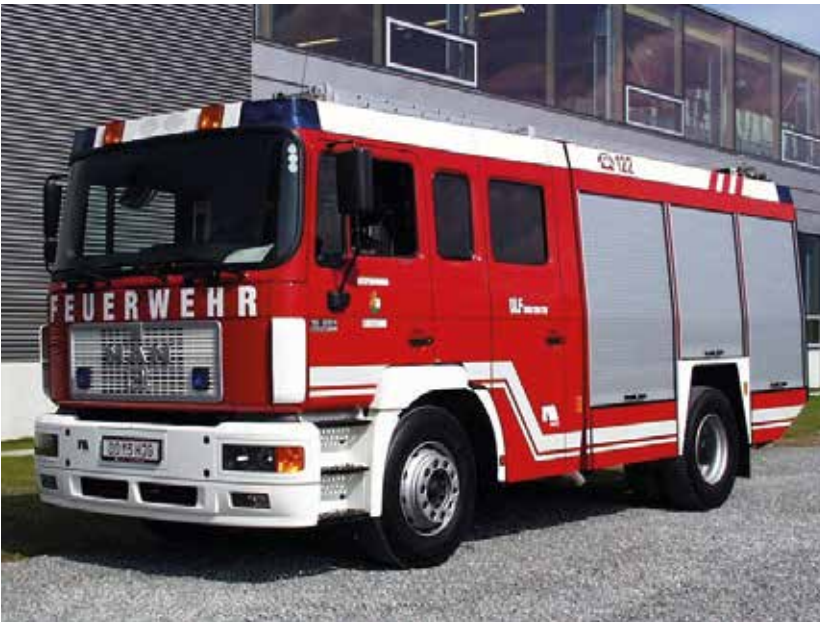
Universallöschfahrzeug 1:8, MAN 18.264, 2000 Liter Wasser, 250 Liter Schaum, 750 kg Pulver, 264 PS, Baujahr 1998
