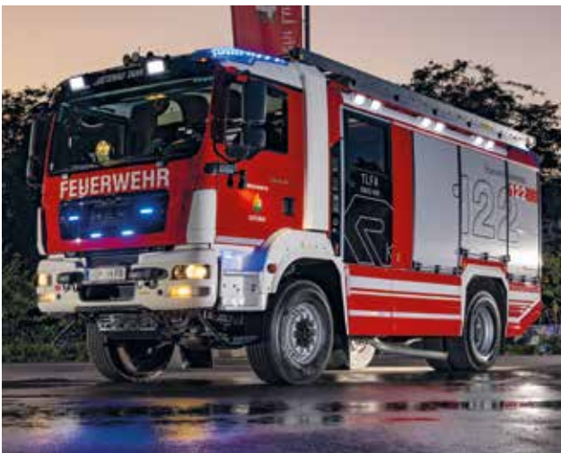
Tanklöschfahrzeug 1:6, MAN-TGM 18.340 4x4, 3000 Liter Wasser, 2x200 Liter Schaum mit CAFS-Anlage, 340 PS, Baujahr 2019
