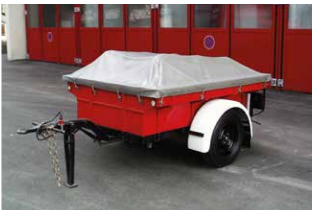
Schlauchanhänger, 3 x 100 m B-Schlauch, Baujahr 1974
