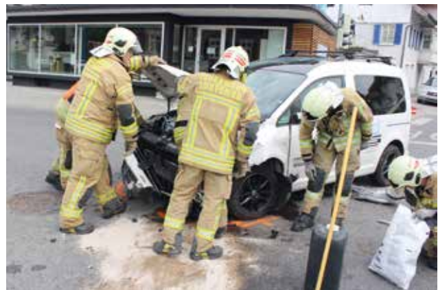
Neben dem Binden des ausgelaufenen Öls musste auch die Batterie des Fahrzeuges abgeklemmt werden.
