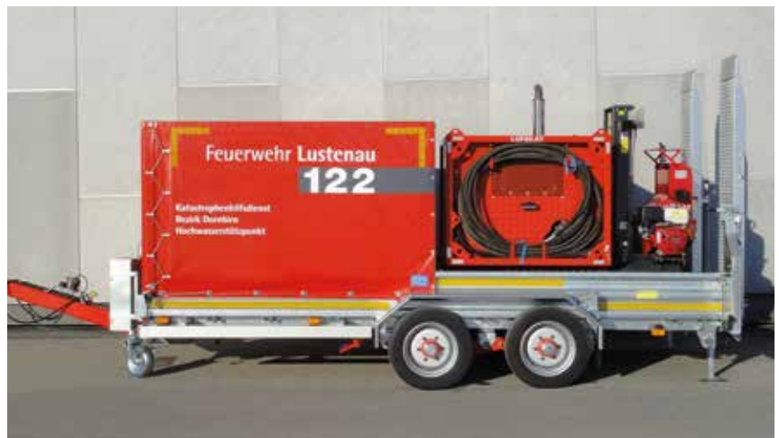
LUF H2O auf Tandemhänger, Hochwasser- und Löschwasserförderpumpe Baujahr 2015
