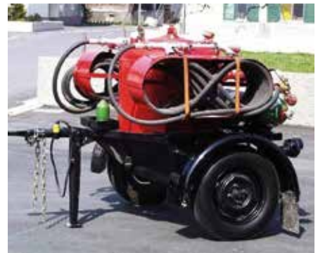
Pulverlöschanhänger, Minimax, 250 kg Löschpulver Baujahr 1963
