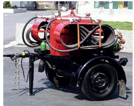
Pulverlöschanhänger, Minimax, 250 kg Löschpulver, Baujahr 1963
