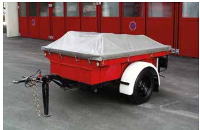
Schlauchanhänger, 3 x 100 m B-Schlauch, Baujahr 1974
