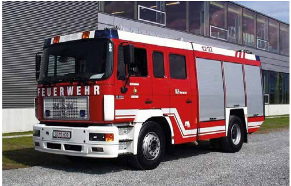
Universallöschfahrzeug 1:8, MAN 18.264, 2000 Liter Wasser, 250 Liter Schaum, 750 kg Pulver, 264 PS, Baujahr 1998
