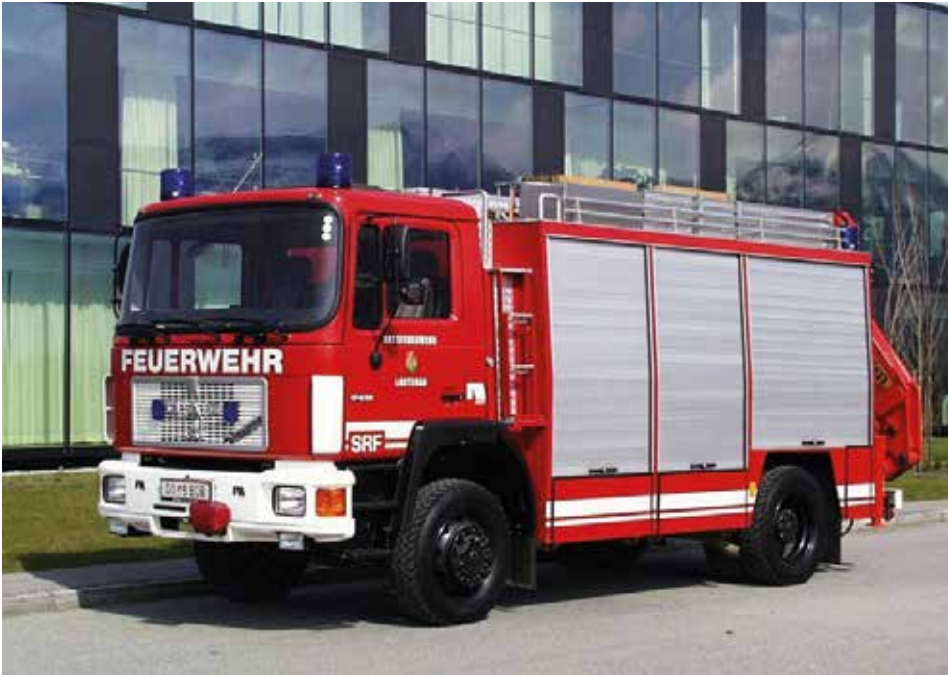
Schweres Rüstfahrzeug-Kran 1:2, ÖAF 17.232 FA, 232 PS, Baujahr 1992
