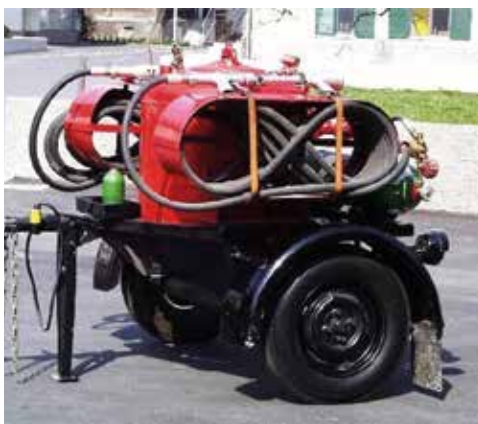
Pulverlöschanhänger, Minimax, 250 kg Löschpulver Baujahr 1963
