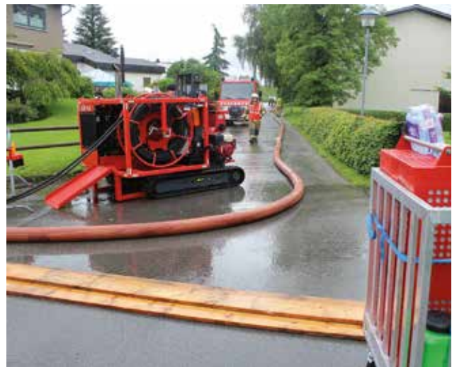
Über eine ca. 200 m lange F-Schlauchleitung wurde das Schmutzwasser ins Rheinvorland abgepumpt
