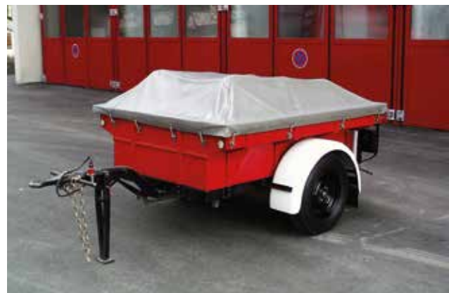
Schlauchanhänger, 3 x 100 m B-Schlauch, Baujahr 1974
