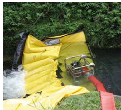
Die Water-Gate-Sperre wurde für die Löschwasserförderung bei der ÖMV nochmals praktisch erprobt
