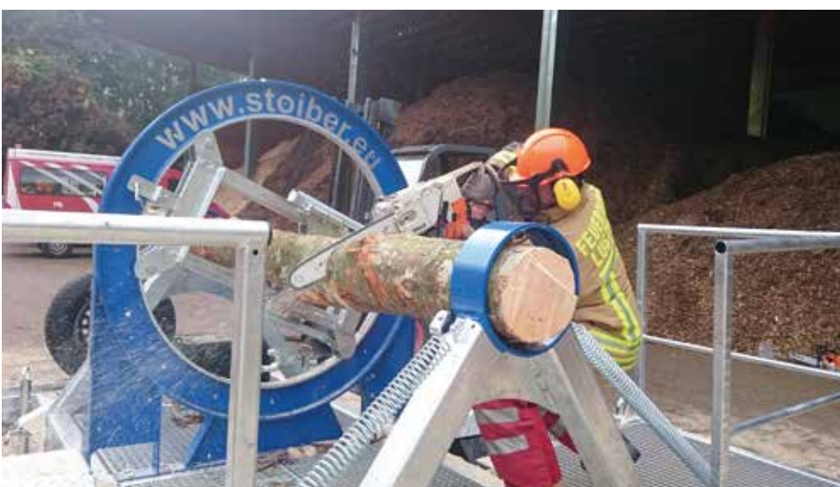
Mit dem Spannungssimulator des Landwirtschaftlichen Forstinstitutes sind sehr praxisnahe Schnittmöglichkeiten von verspannten Holzstämmen möglich
