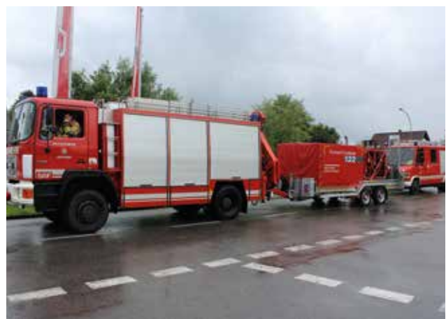
Das LUF H20 wird mit dem Rüstfahrzeug an die jeweilige Einsatzstelle gebracht. Die Begleitmannschaft rückt mit einem Löschfahrzeug und einem Versorgungsfahrzeug nach.
