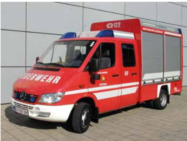
Kleinrüstfahrzeug 1:5, Mercedes Sprinter 416 CDI, 156 PS, Baujahr 2005
