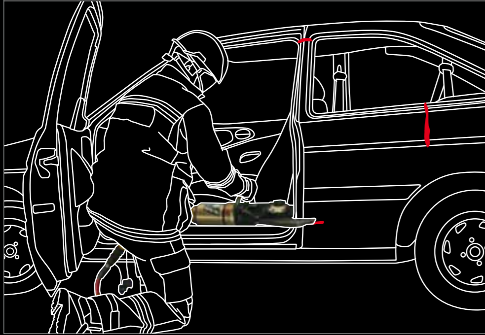
1 An markierten Punkten einschneiden Cut at cutting points
