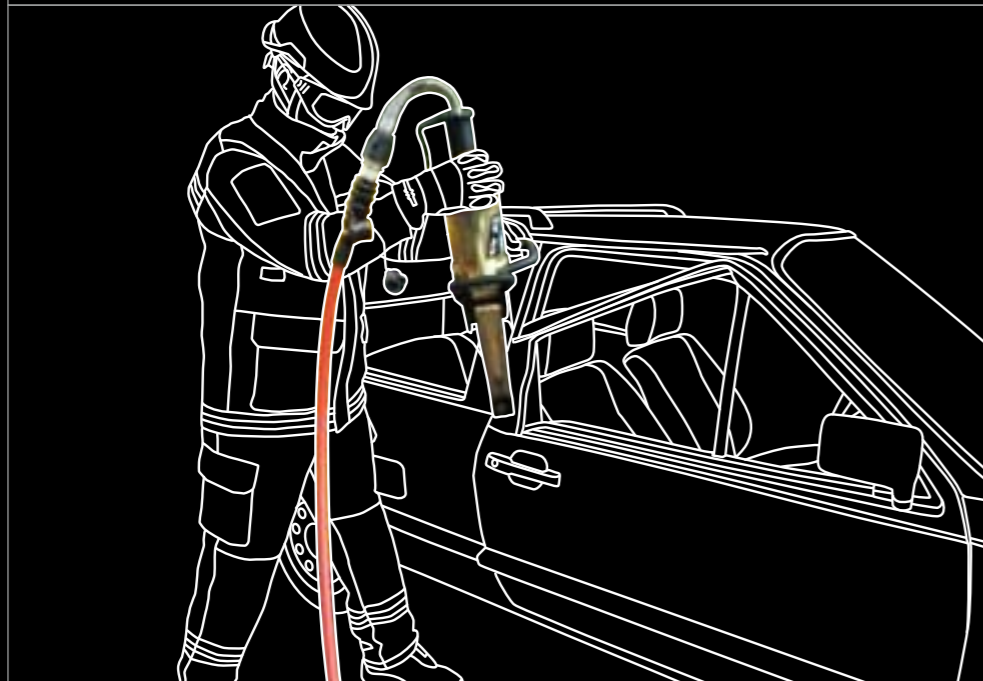
3 Beim Schließen rutscht Spreizer nach (Schwerkraft) During closing the spreader slides in (gravity)
