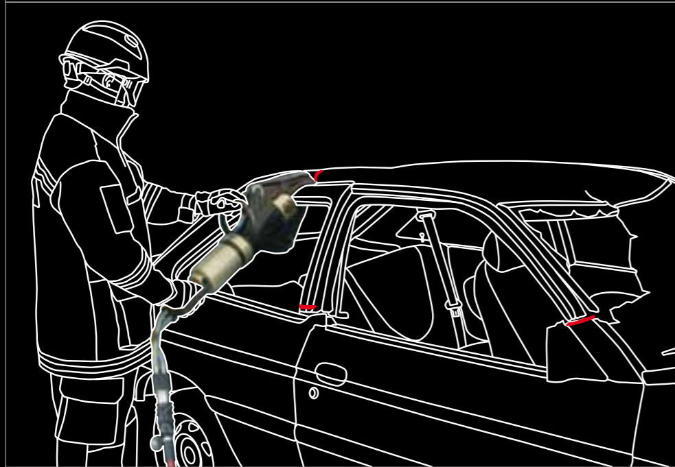
3 An Schnittpunkten schneiden Cut at cutting points
