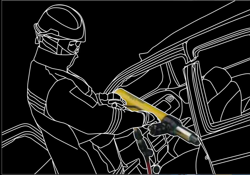
2 Rettungszylinder einsetzen Apply rescue ram
