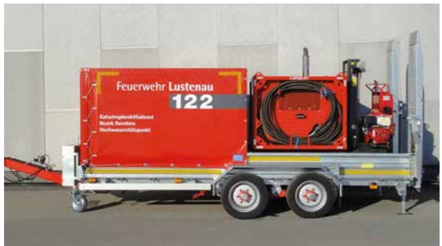
LUF H2O auf Tandemhänger, Hochwasser- und Löschwasserförderpumpe
