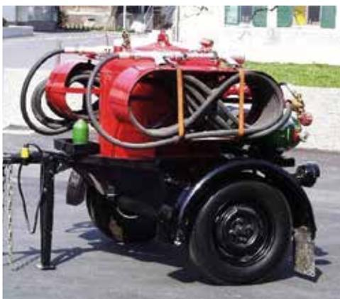
Pulverlöschanhänger, Minimax, 250 kg Löschpulver
