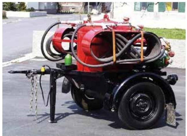
Pulverlöschanhänger, Minimax, 250 kg Löschpulver, Baujahr 1963
