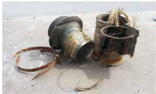
Originale Saugschlauchverschraubung vor der Restauration
