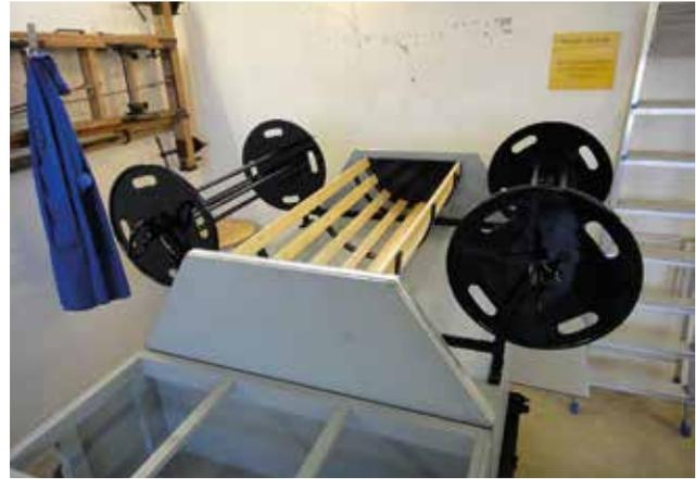
Aufbau hinterer Geräteraum mit Schlauchhaspeln und Schlauchtrog
