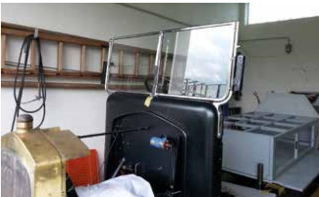
Neu verglaste und vernickelte Windschutzscheibe mit Winkergehäusen
